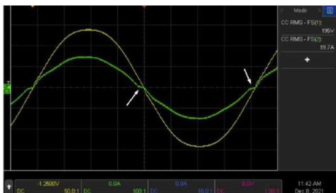
Figura 9: Forma de onda de corrente distorcida, produzida pelo método AFD. Fonte: Evaluation of AFD Islanding Detection Methods Based on NDZs Described in Power Mismatch Space
