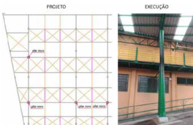
Figura 5: Exemplo de reforço realizado nas tesouras de um telhado de estruturas metálicas. Fonte: Canal Solar (2021)
