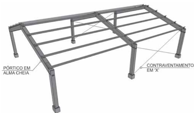
Figura 2: Edifício industrial de duas águas com pórtico em alma cheia. Fonte: Instituto Aço Brasil – Centro Brasileiro da Construção em Aço (2010)
