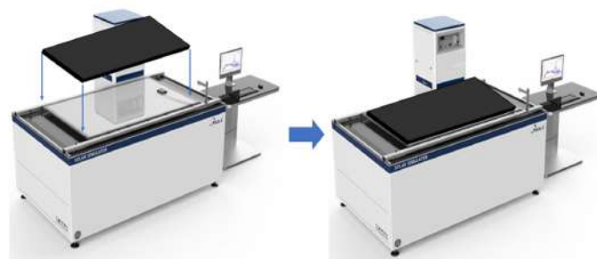
Figura 5 - Realização do teste de flash em módulos bifaciais
