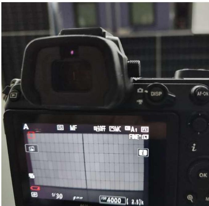
Figura 2: Câmera portátil de eletroluminescência (EL). Fonte: LESF/UNICAMP
