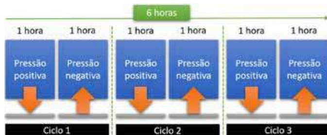
Etapas do teste de carga mecânica estática. Fonte: LESF/UNICAMP
