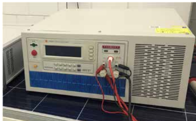
Fonte de alta tensão usada no teste de isolamento do módulo fotovoltaico. Fonte: LESF/UNICAMP
