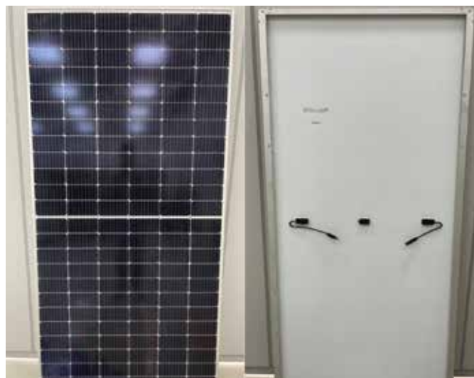
Procedimento de inspeção visual do módulo fotovoltaico. Fonte: LESF/UNICAMP
