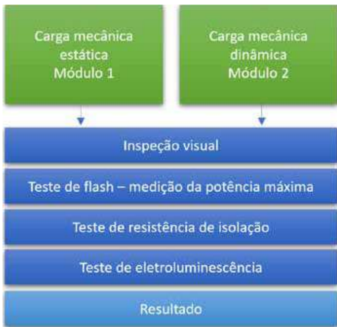
Fluxograma simplificado do escopo dos testes de carga mecânica. Fonte: LESF/UNICAMP
