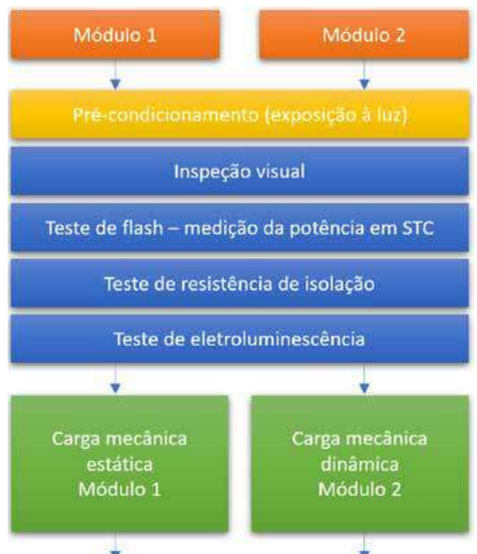
Etapas do teste de carga mecânica dinâmica. Fonte: LESF/UNICAMP
