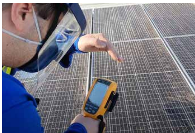
Câmera termográfica analisando a temperatura dos módulos. Foto: Canal Solar
