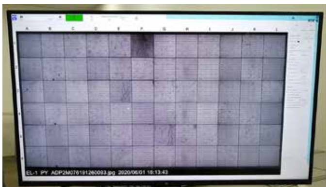
Imagem de eletroluminescência revelando a existência de células danificadas em um módulo fotovoltaico. Fonte: LESF/UNICAMP
