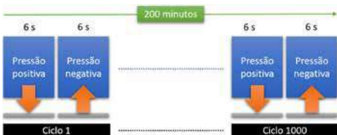
Etapas do teste de carga mecânica dinâmica. Fonte: LESF/UNICAMP
