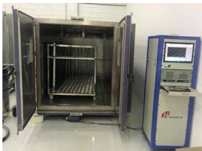
Figura 2: Câmara climática “damp heat” para controle de calor e umidade (à esquerda) e módulo de monitoramento com fonte de alta tensão (à direita)
