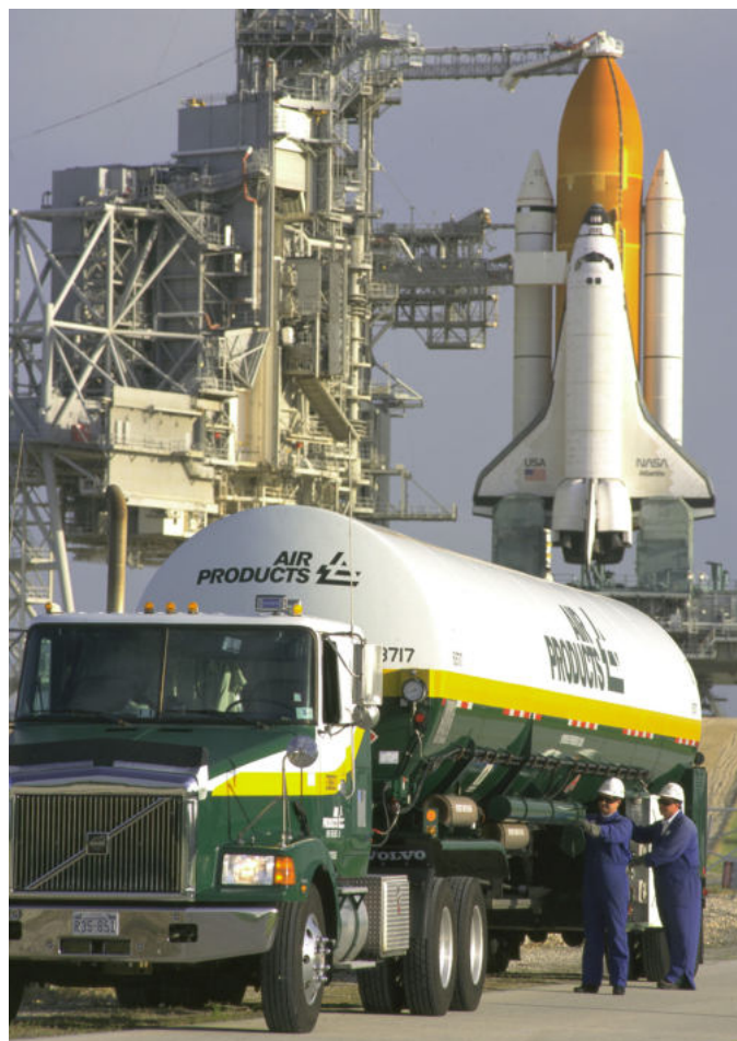
A Air Products fornece todos os requisitos de hidrogênio líquido da NASA no Centro Espacial Kennedy. O hidrogênio é usado para abastecer os três motores principais do ônibus espacial (SSME) desde a decolagem até a inserção do orbitador na órbita terrestre baixa. Foto: AirProducts/Divulgação
