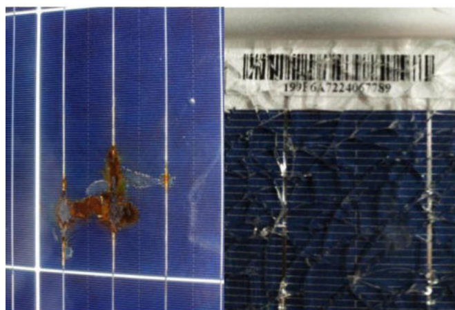
Figura 3: Módulos fotovoltaicos avariados (arquivo dos autores)
