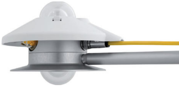
Figura 5: Albedômetro: instrumento usado para medir o albedo de uma superfície. Fonte: Kipp&Zonen
